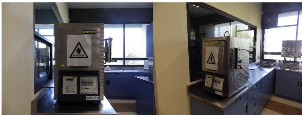
Figura 17. Horno de la marca Naberthem con capacidad de calentamiento de  $30\text{-}1800^{\circ}\text{C}$
