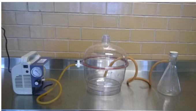
Figura 19. Equipo adaptado para generar vacío.
