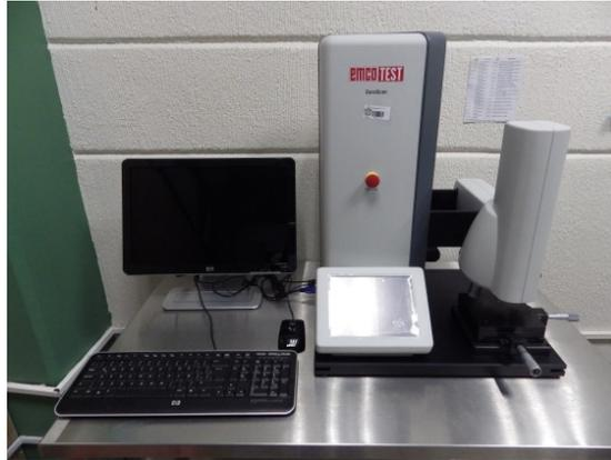
Figura 23. Durómetro de la marca Emco-TEST-DuraScan.
