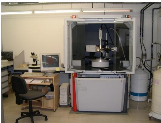
Figura 10. Equipo de difracción de rayos x
