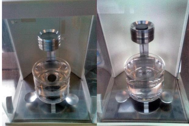
Figura 20. Calculo de peso en seco, peso suspendido y peso saturado
