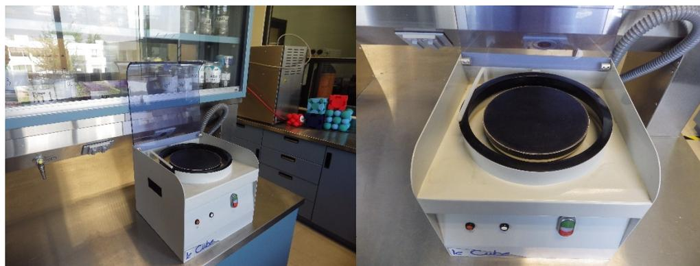
Figura 21. Pulidora de la marca Le Cube
