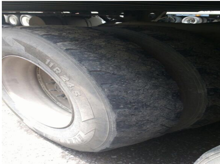
Figura 7: Neumáticos con severo desgaste, utilizados para el traslado del producto.
