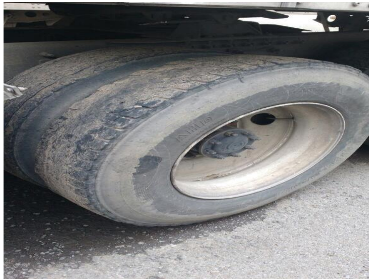
Figura 8: Neumático desgastado en unidad tracto camión.
