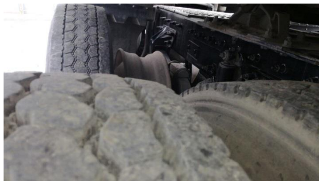
Figura 6: Unidad Tracto Camión, falta de neumático #4
