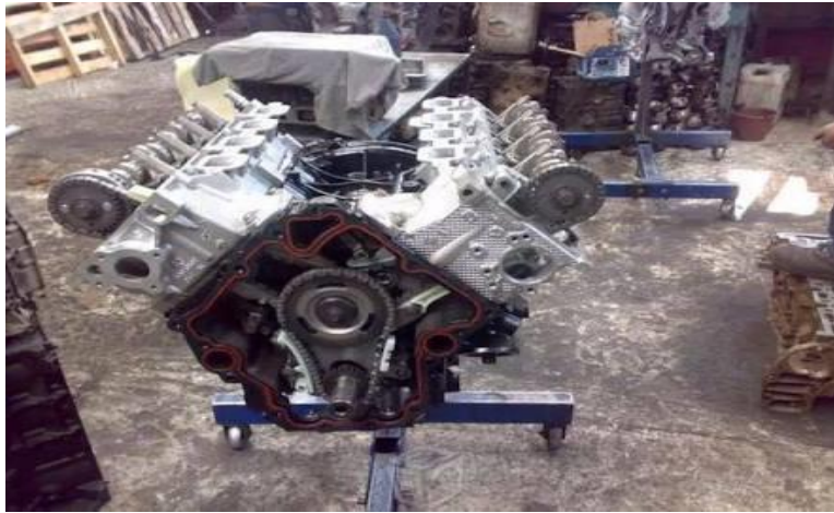
Figura 12: Motor de unidad propia aplicando medio ajuste a falta de mantenimiento preventivo
