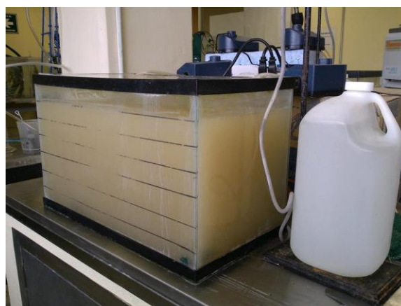
Figura 4.2 Reactor SBR de 30 L
