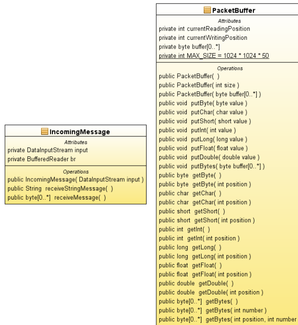
Figura 6.9: Diagramas de las clases IncomingMessage y PacketBuffer
