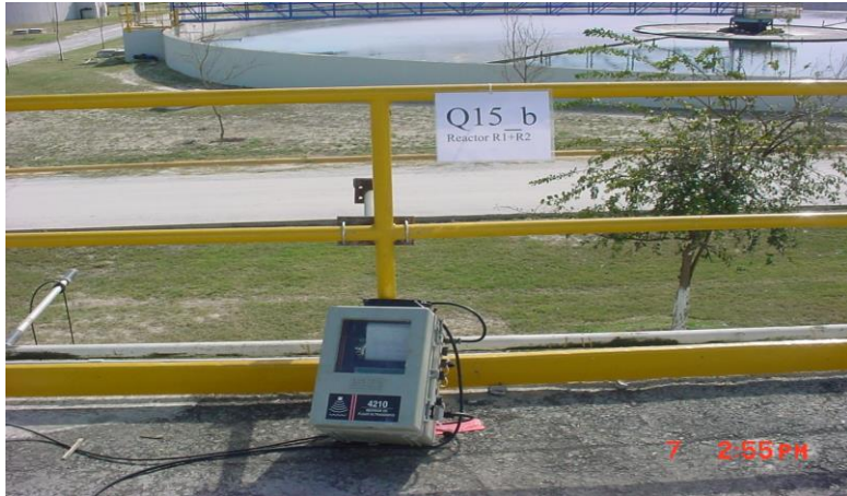
Medidor ultrasónico en efluente de R_1 + R_2 ( Q_{15b} ). Flujo en canal.
