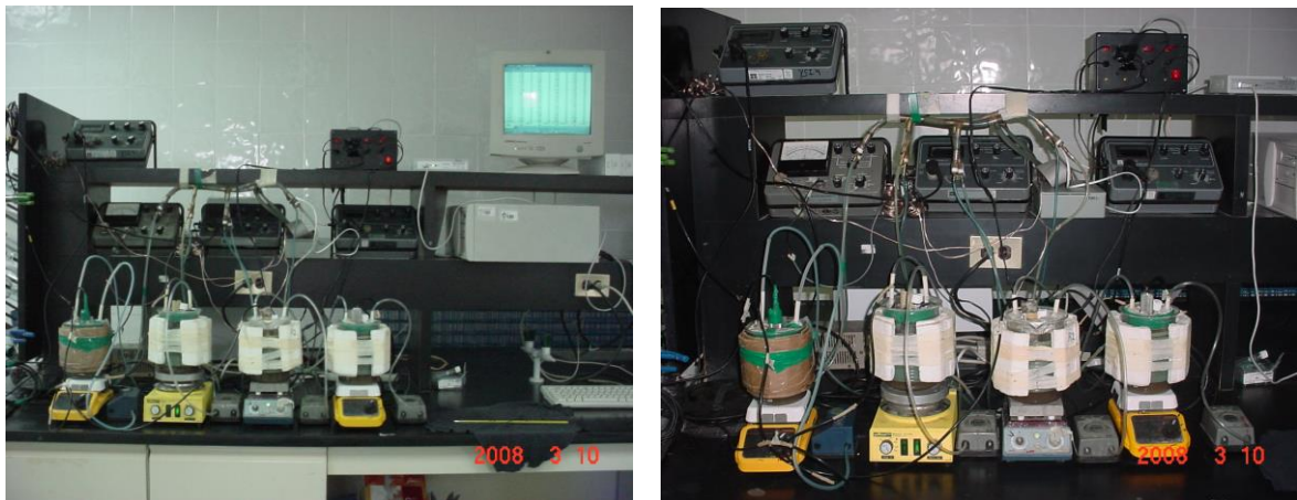
Equipo utilizado para las pruebas de respirometría en la PTAR “Dulces Nombres”
