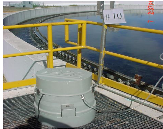
Muestreadores automáticos en influente a reactores, (6), en efluente de CS_2 (10) y en efluente de CS_{1,3,4,5,6} (16 marcado como #17)
