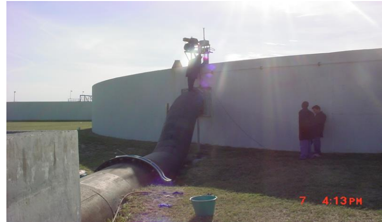
Medición de Q 20 (by-pass CP 4 ) con trazador. Tubo 24"
