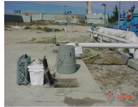
Muestreadores automáticos en influente a reactores, (6), en efluente de CS_2 (10) y en efluente de CS_{1,3,4,5,6} (16 marcado como #17)
