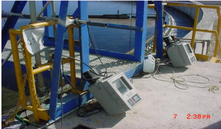
Medidores ultrasónicos en vertedor de CS 2 (Q 11A y Q 11B )
