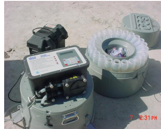
Detalles del muestreador automático utilizado en la campaña intensiva de muestreo y análisis
