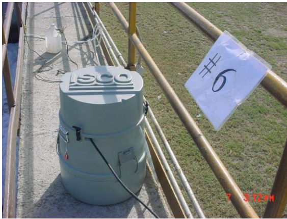
Muestreadores automáticos en influente a reactores, (6), en efluente de CS_2 (10) y en efluente de CS_{1,3,4,5,6} (16 marcado como #17)
