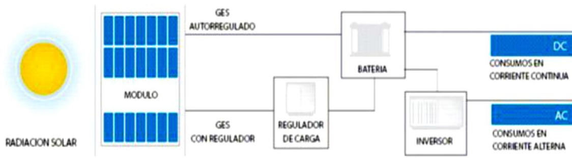
Imagen 19. Esquema de proceso de almacenamiento de energía solar
