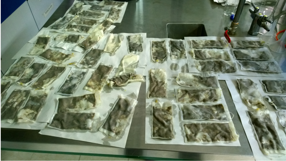
Figura 4. Bolsas lavadas en secado, previo a ser introducidas a la estufa de aire forzado.
