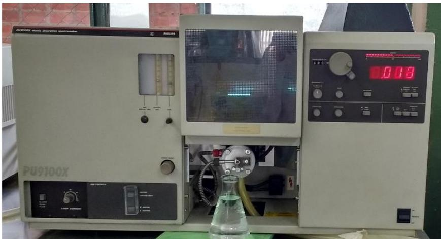
**Figura 2.** Espectrómetro de Absorción Átomica
