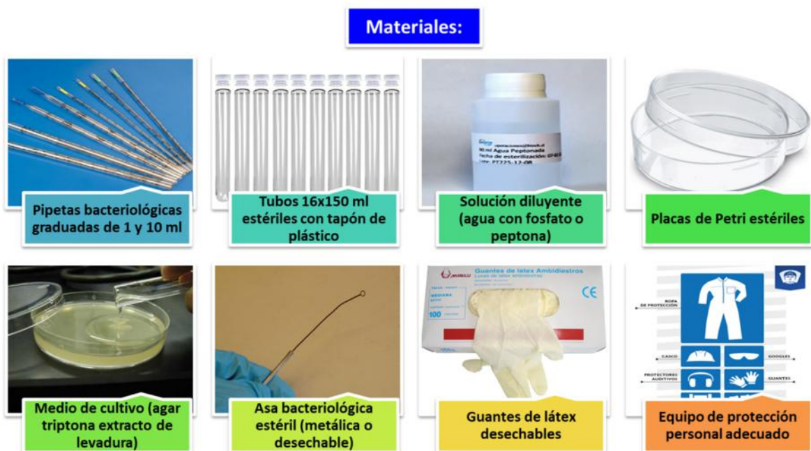
Figura 29. Material a emplear para el método de cuenta total de mesófilos aerobios, de acuerdo con las normas NOM-092-SSA1-1994 y NOM-110-SSA1-1994. Fuente: Autoría propia.
