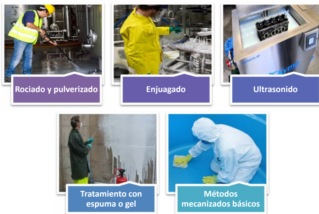
Figura 11. Ejemplos de limpieza con métodos mecánicos. Fuente: Autoría propia.
