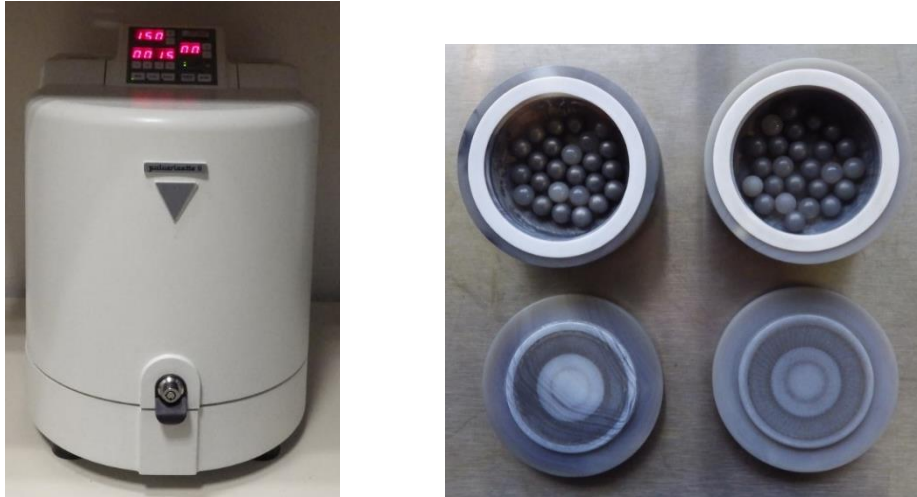
Figura 14. Molino planetario marca FRITSCH, contenedor de ágata y bolas de molienda de zirconia
