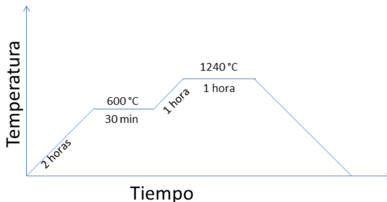
Figura.17. Ciclo de calentamiento o Rampa de sinterización
