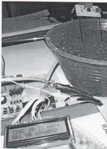
Figura 3.9 Toma de medida a un suelo húmedo.
