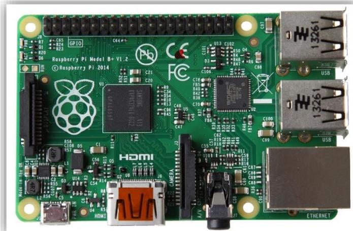
Figura 8 Plataforma Raspberry Pi.
