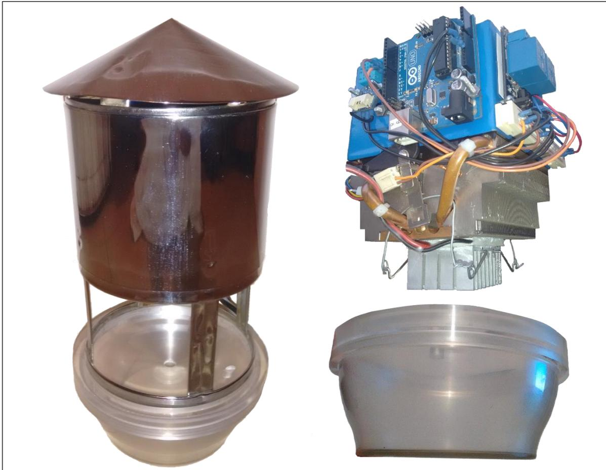
Figura 34 Dispositivo final: Captura de agua del medio ambiente
