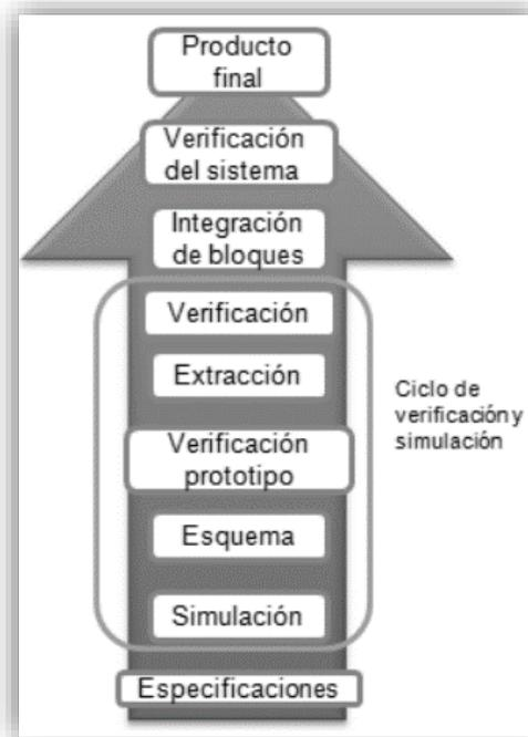
Figura 26 Diseño Bottom Up.
