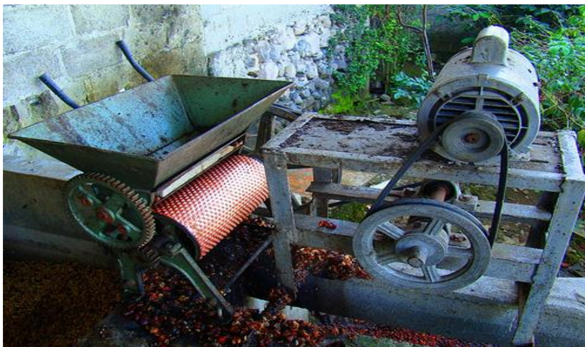
Foto 7.- Imagen de despulpadora de café con motor
