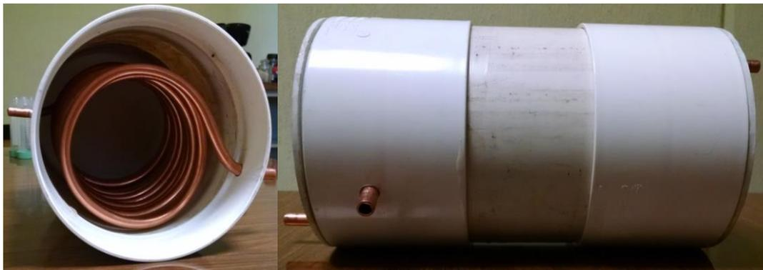
**Fig.A. 4 Intercambiador de calor helicoidal escala laboratorio**
