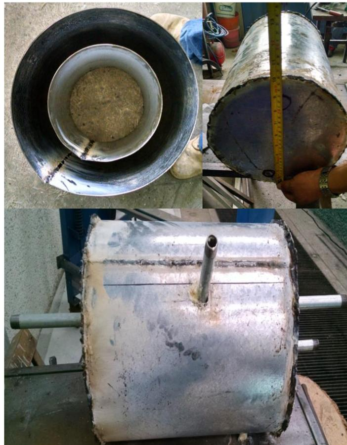
**Fig.A. 7 Construcción de termotanque de captador solar**
