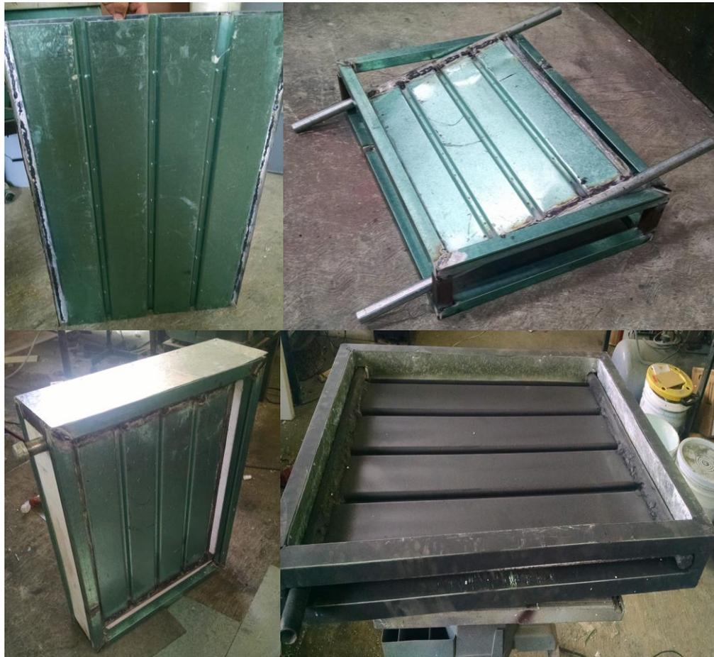
**Fig.A. 6 Construcción de placa de adsorción**
