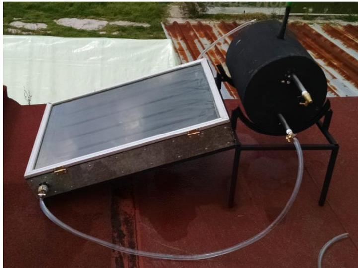
**Fig.A. 8 Calentador solar de placa plana escala laboratorio**
