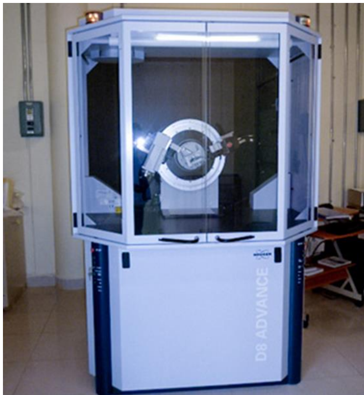
Figura 21 Difracción de rayos X de polvos. (CCIQS, 2008)
