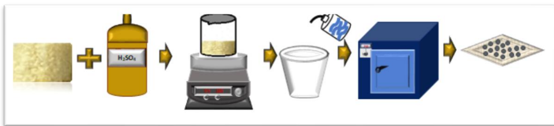
Figura 6. Sistema experimental utilizado para las pruebas de sulfonación de EPS. Fuente: elaboración propia.
