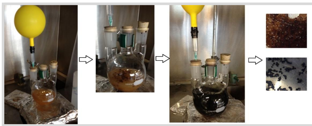
Figura 7. Sistema experimental utilizado para obtener NPs de óxidos de hierro soportadas en EPSS. Fuente: elaboración propia.
