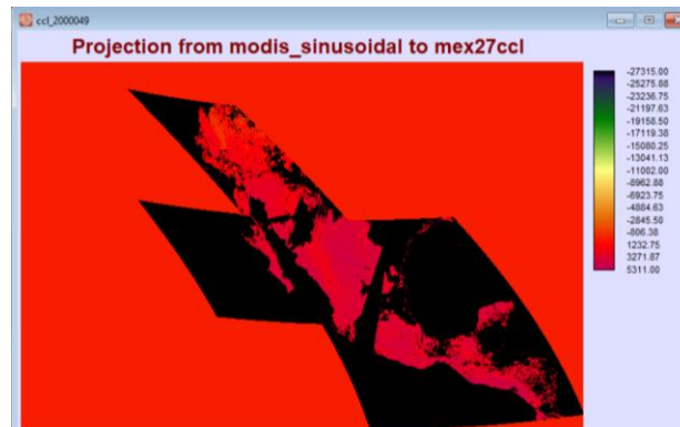
Figura 10. Transformación de sistema de referencia a Cónica Conforme de Lambert
