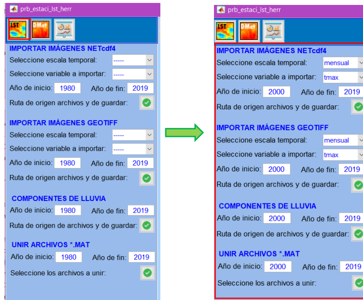
Figura 29. Modulo para ingresar imágenes Daymet y exportarlas en formato *.mat para su posterior análisis
