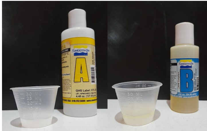
Figura 25 Proporción A y B para el barnizado
