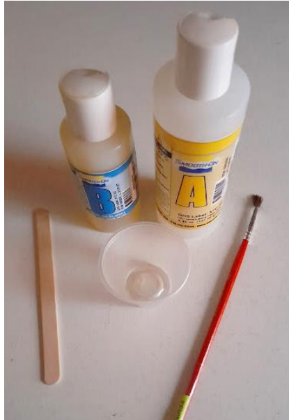
Figura 24 Materiales utilizados en el barnizado con XTC-3D
