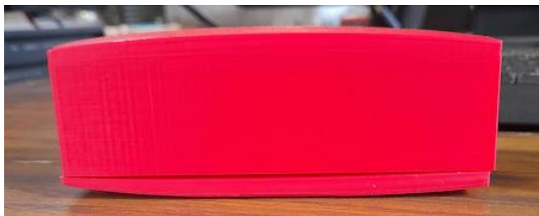
Figura 52 Molde impreso que presenta warping.
