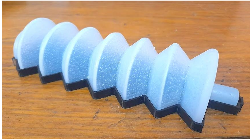
Figura 34 Última fase de sellado de la silicona en el actuador.
