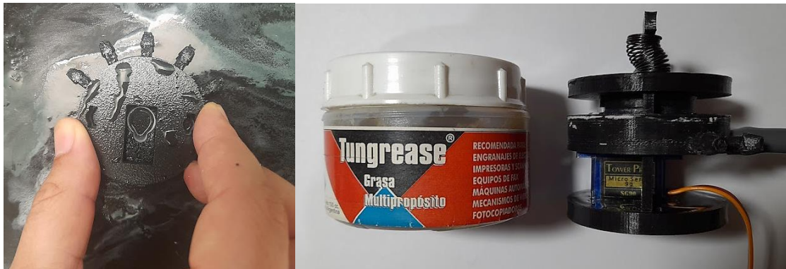
Figura 41 Pulido y engrasado de las piezas de la válvula.
