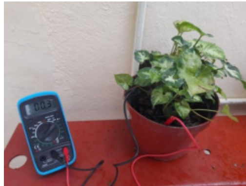
Figura 8.19. Lectura de Corriente de la Planta Singonio.
