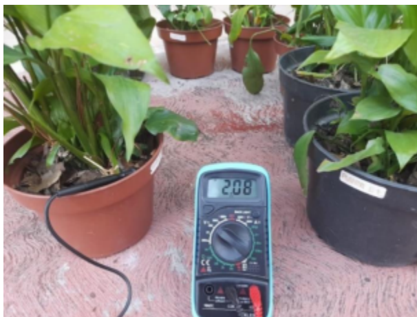
Figura 9.2 Voltaje obtenido de la conexión en serie de 8 ejemplares.
