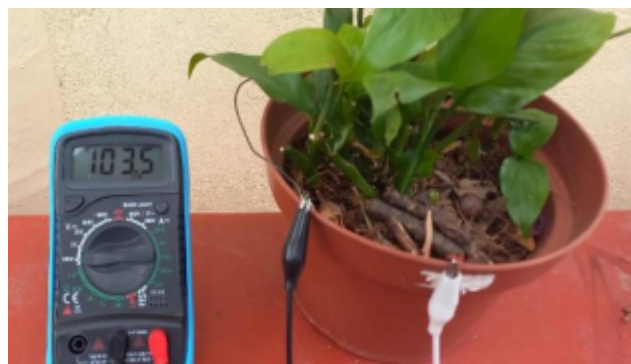
Figura 8.4. Prueba demostrativa de una celda con organismo vegetal (planta).
