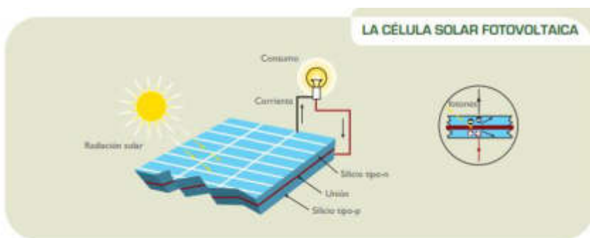
Figura 7.5. La célula fotovoltaica (SCHALLENBERG Y HERNÁNDEZ, 2008).
