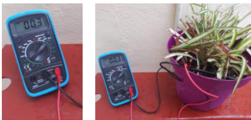
Figura 8.10. Lectura de Corriente de la planta CINTA.
