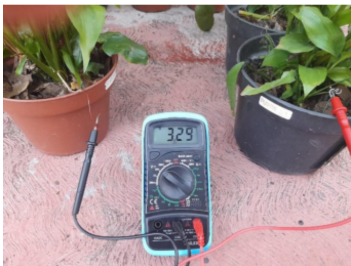
Figura 9.3 Voltaje obtenido de la conexión en serie de 14 ejemplares.
