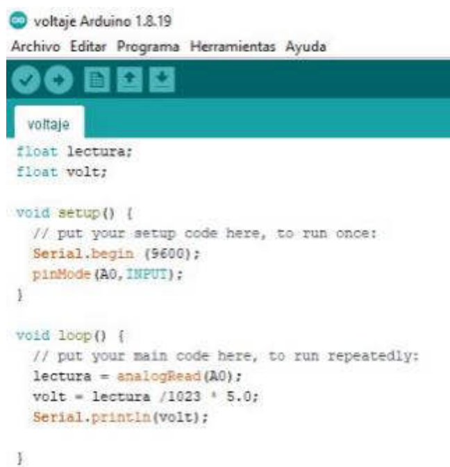
Figura 8.49 Sketch o instrucciones para programar la medición del voltaje.
