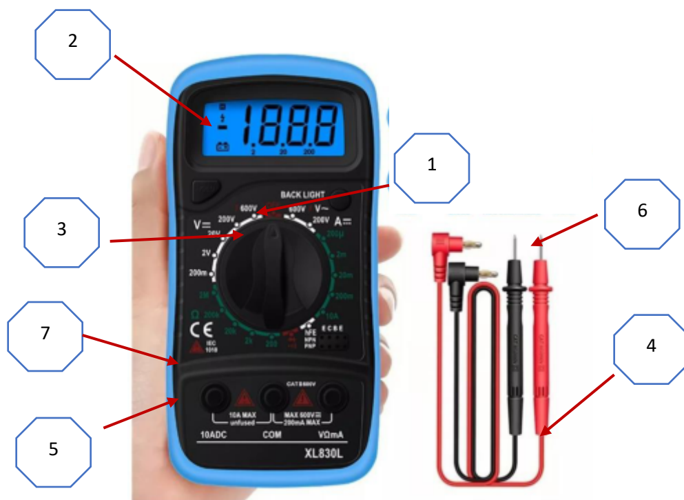
Figura 7.21. Componentes de un multímetro digital (Universidad de Buenos Aires, 2020).
