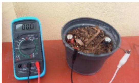
Figura 8.3. Prueba demostrativa de una celda sin organismo vegetal (planta).
