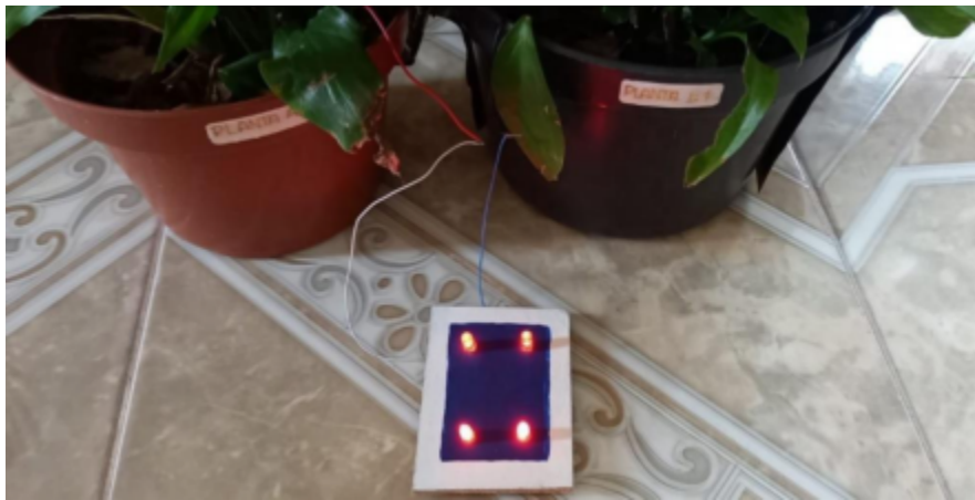
Figura 9.7 Prototipo demostrativo conectado al circuito en serie de 14 ejemplares.
