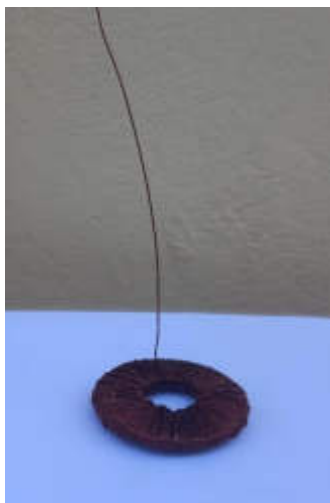
Figura 8.34. Imagen representativa del Ánodo espiral de alambre de cobre.
