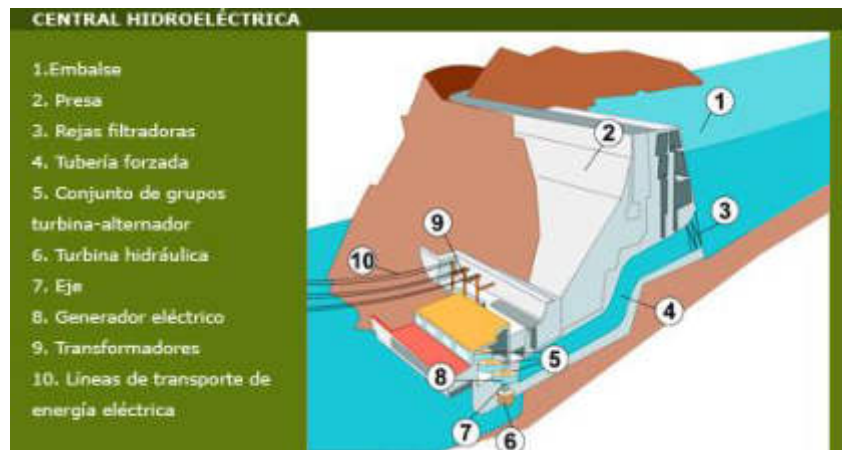
Figura 7.7 Central hidráulica (SCHALLENBERG Y HERNÁNDEZ, 2008).
