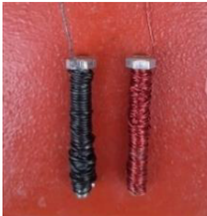
Figura 6.1. Electrodos base de acero inoxidable con embobinado de cobre y aluminio
