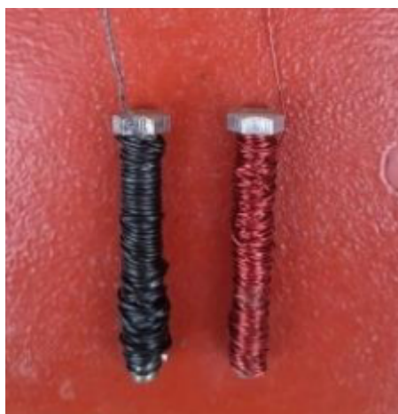
Figura 8.2. Electrodo base de acero inoxidable con embobinado de cobre (Cu) y aluminio (Al) (cátodo y ánodo).
