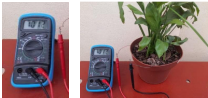
Figura 8.12. Lectura del Voltaje de la Planta Lirio de la Paz.
