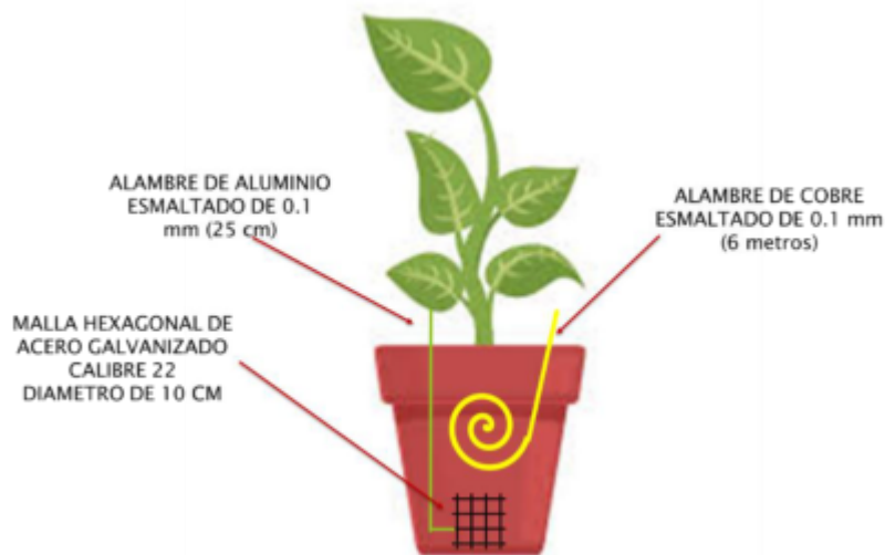
Figura 6.3. Prototipo 2 Celda Eléctrica con ánodo de espiral y cátodo de rejilla.
