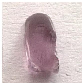
Fig. 3.4 Vidrio BBO:Nd 3+ cortado (6.72mm x 8.84mm x 3.44 mm) y pulido con calidad óptica.
