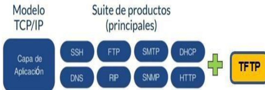
Ilustración 5. Protocolos en capa de Aplicación (Modificado de (Meza, Platzi, 2024)).
