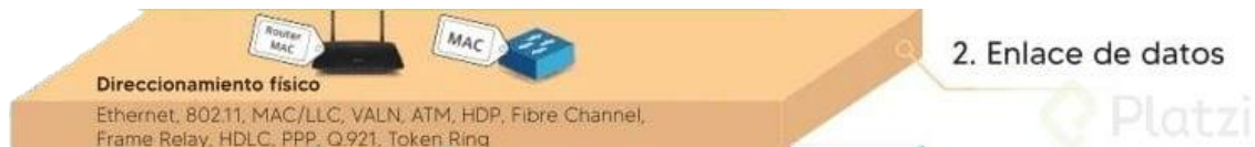
Ilustración 17. Capa 2 del modelo OSI.
