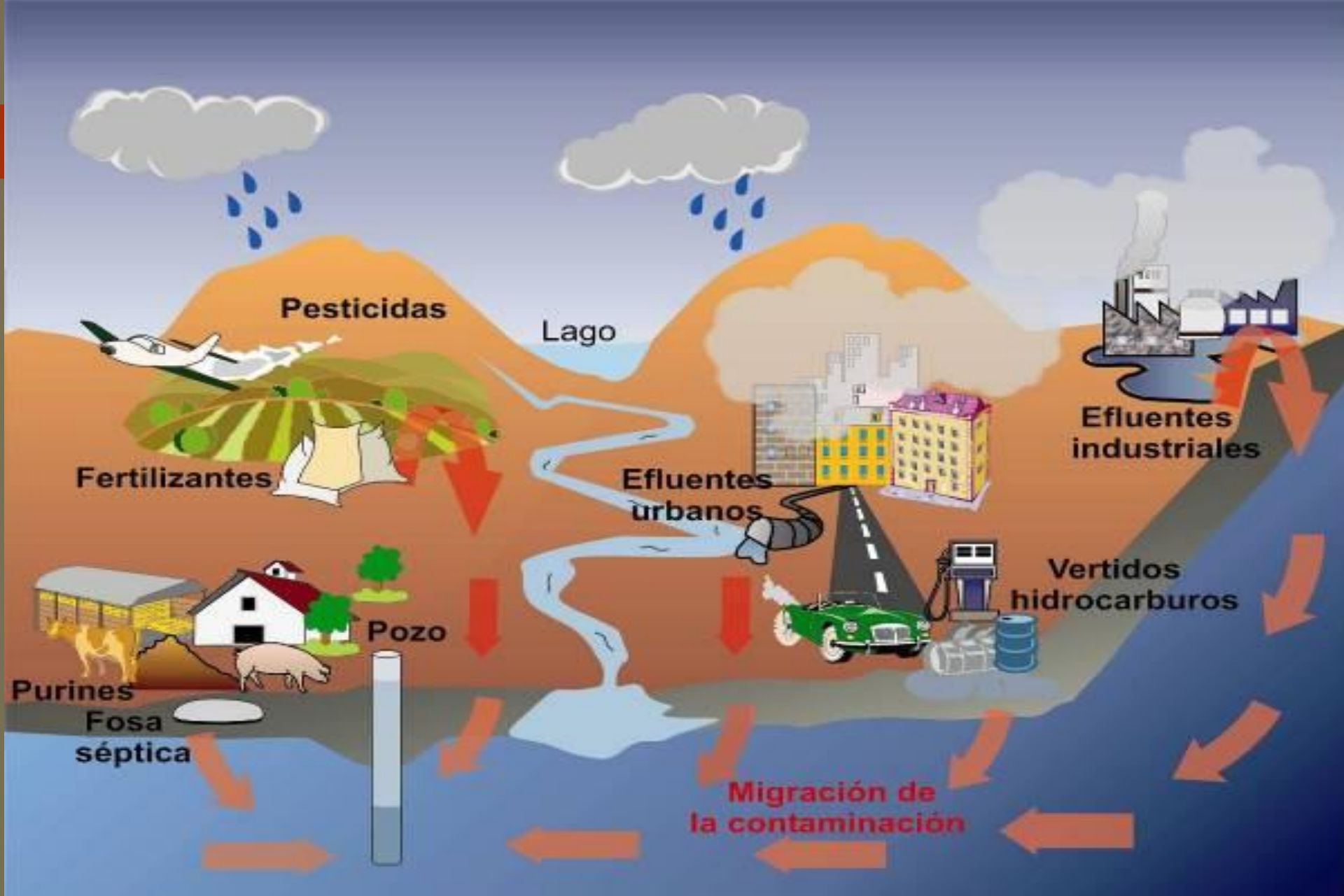
Fig. 3. Ejemplos de contaminantes y su transporte en el ambiente
