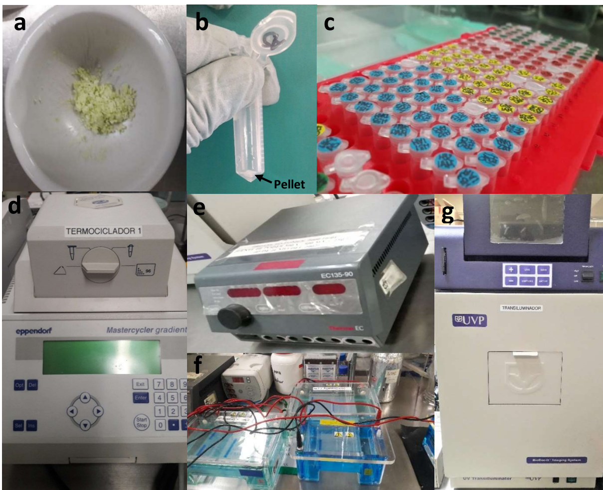
Figura 12. Proceso de amplificación de ADN: a) Muestra de tejido de As, b) Obtención de pellet de ADN, c) Tubos Eppendorf con las mezclas para la PCR, d) amplificación del ADN en el termociclador, e) y f) corrimiento electroforético, g) exposición del gel de agarosa a la luz UV en el transiluminador.
