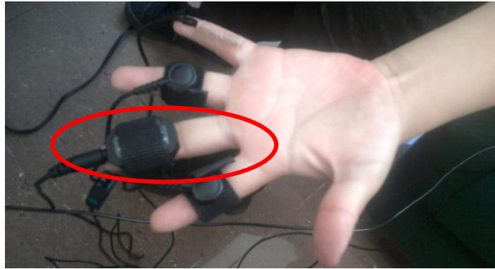
Figura 15. Ejemplo de la colocación del fotopleletismógrafo, en la falange media del dedo medio, de la mano izquierda de los participantes.
