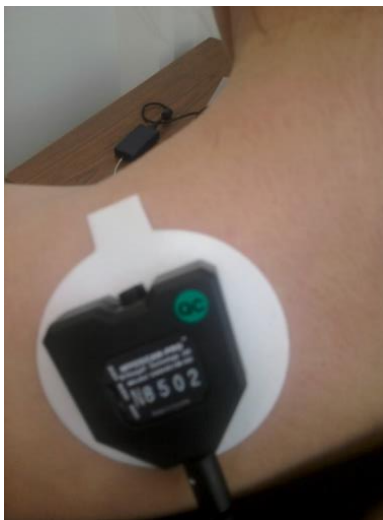
Figura 13. Ilustración de la forma en que se adhirió el electromiógrafo superficial, en el músculo trapecio superior izquierdo de los participantes.
