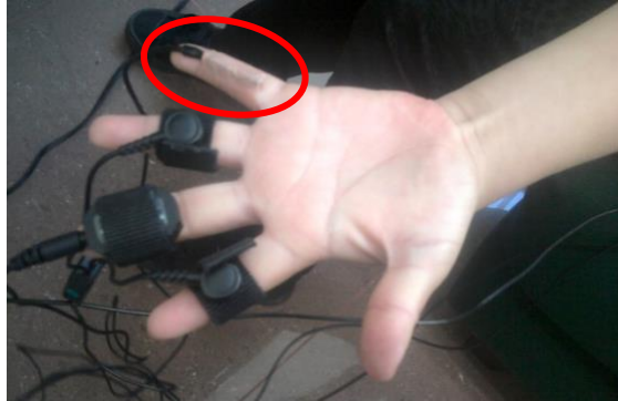
Figura 17. Ejemplificación de la forma en que fue adherido el sensor de temperatura cutánea periférica, en el dedo menique de la mano izquierda de los participantes.
