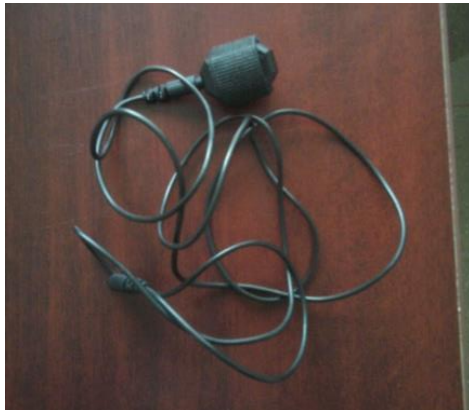
Figura 14. El empleo del fotopletismógrafo, permitió medir la vasoconstricción de los participantes.
