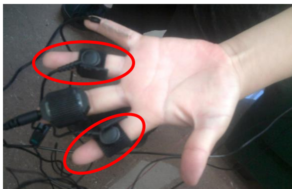
Figura 19. Ilustración de la forma en que se colocaron los sensores GCR, en la falange media de los dedos índice y anular, de la mano izquierda de los participantes.
