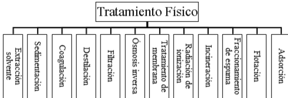
Figura 3. Tratamientos Físicos que se utilizan para la eliminación de sólidos suspendidos que se encuentran en aguas residuales (Ameta, 2018)
