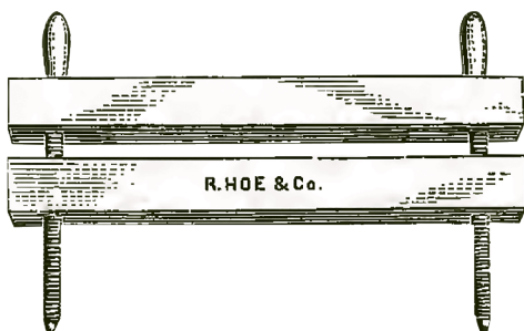
IMAGEN 5. Prensa para encuadernación. Varios tamaños. Inventarios de 1852, 1861, 1863 y 1890. Procedencia de la imagen: R. Hoe, 1873, p. 82.
