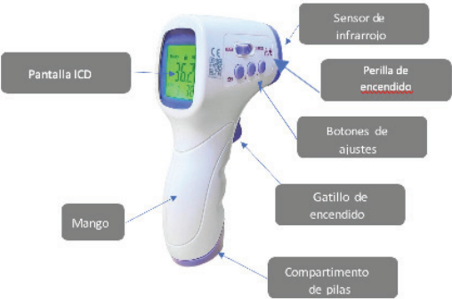
Figura. 1. Parte 1: Descripción de principales componentes. Instrumento de medición para la temperatura utilizando rayo láser.
