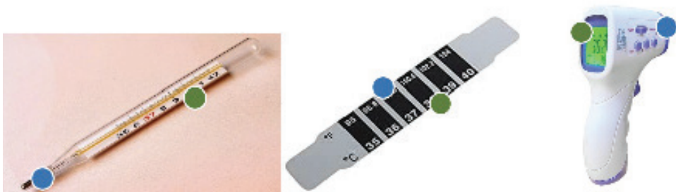
Figura 2. Etapa 3: comparación del lenguaje en diversos productos. Tres tipos de termómetros: el de mercurio, el de sensores de calor y el de rayo láser.
