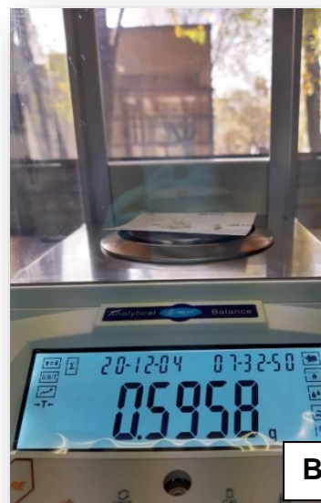
Figura 4B. Registro de la masa del cemento obtenida en gramos en la balanza analítica.
