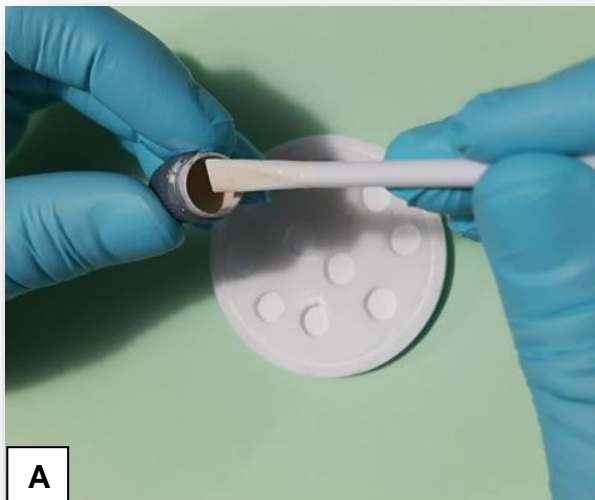
Figuras 8A y 8B. Elaboración y manipulación de los bloques de cemento a base de silicato tricálcico purificado en el molde de silicona para la microdureza y resistencia a la flexión.
