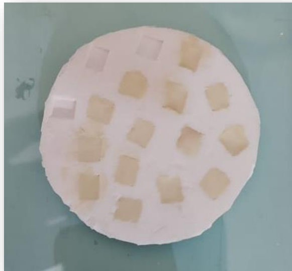
Figura 10. Elaboración de los bloques a base de STP en el molde de silicona para evaluar la resistencia a la compresión.
