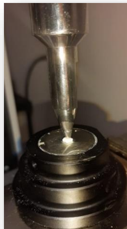
Figura 19. Bloque en proceso de medición para la resistencia a la compresión en la máquina universal de ensayos.
