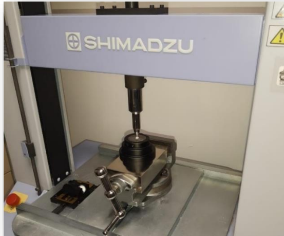
Figura 18. Colocación de los bloques en la base de la máquina universal de ensayos.
