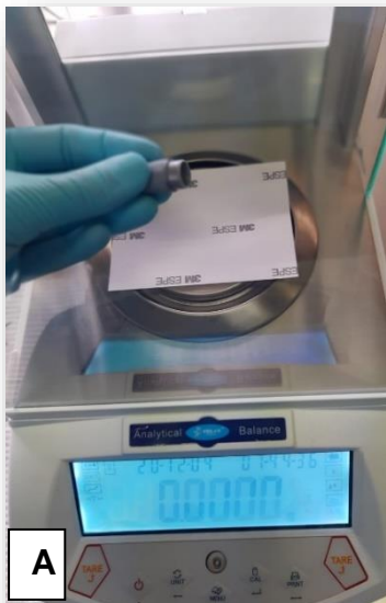
Figura 4A. Colocación del polvo del cemento a base de silicato tricálcico purificado sobre la balanza analítica para ser pesado.
