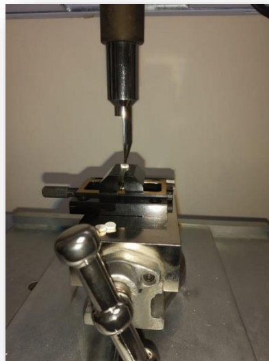
Figura 23. Bloque en proceso de medición para la resistencia a la flexión en la máquina universal de ensayos.
