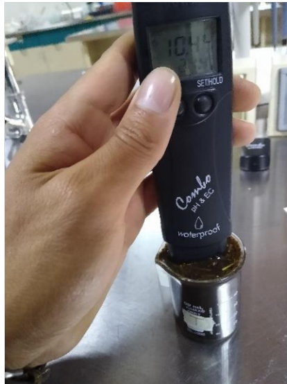
Figura 9. Medición de pH y conductividad eléctrica de los distintos tratamientos de compostas.
