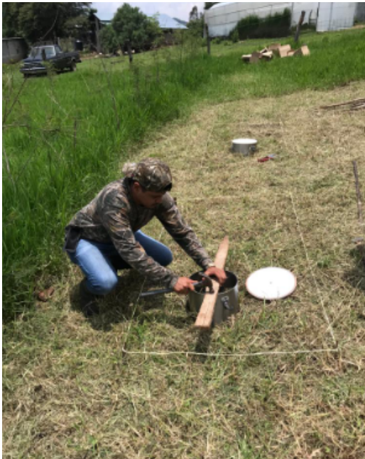
Figura 28. Colocación de las cámaras estáticas captadoras de gas.
