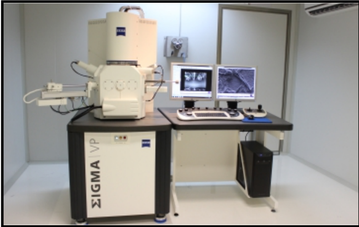
Figura 10. Microscopio electrónico de barrido de emisión de campo (Carls Zeiss), propiedad del Servicio Nacional de Sanidad, Inocuidad y Calidad Agroalimentaria (SENASICA).
