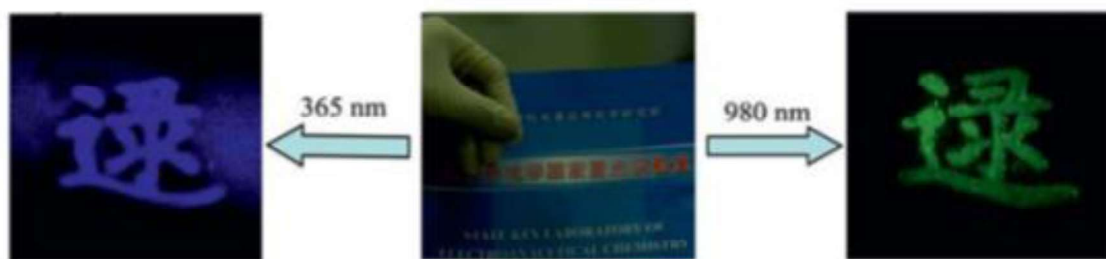
Fig. 1.28 Ejemplo de una tinta de seguridad basada en nanocristales de \text{NaYF}_4: \text{Yb,Er} con emisión dual. Proceso DC (izquierda) y UC (derecha) (Liu, et. al. , 2011).
