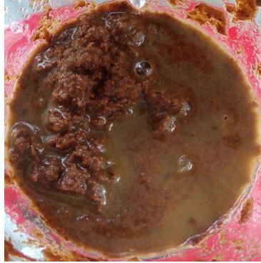
Figura 2.3. Mezcla licuada de sargazo y agua desionizada.
