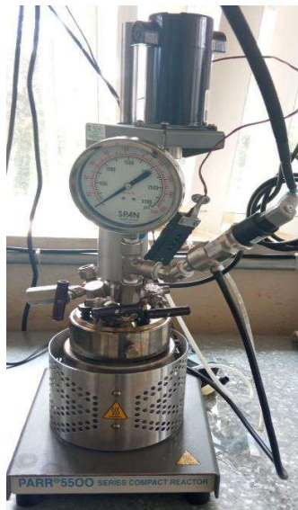
Figura 2.2. Reactor utilizado para las pruebas de carbonización hidrotermal.
