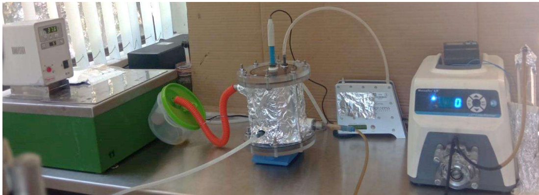
Figura 2.6. Proceso de digestión anaerobia con alimentación en continuo.
