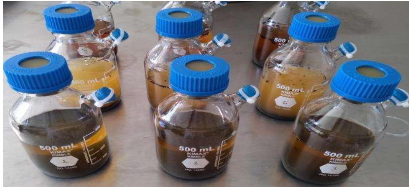
Figura 2.5. Reactores utilizados en la prueba de digestión anaerobia por lote.
