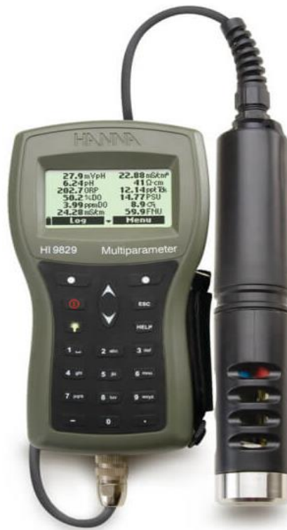
Figura 3.3 Multiparamétrico marca HANNA, modelo HI 9829 Fuente: HANNA instrument
