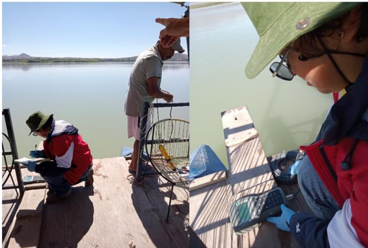
Figura 3.7 Lectura de datos paramétricos de calidad del agua con multiparamétrico
