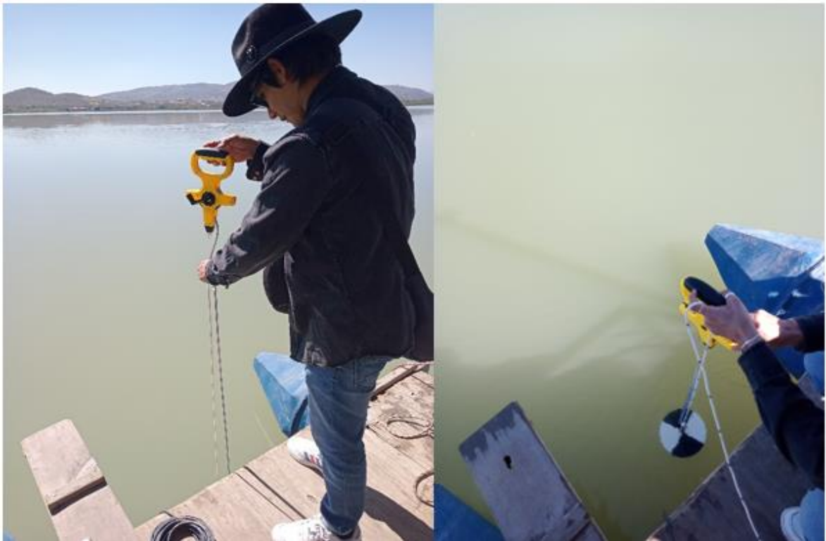
Figura 3.9 Medición y registro de la transparencia con disco Secchi
