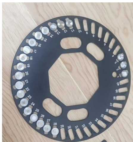
Figura 4.7.2. Porta muestra del Lexsyg Smart donde se ubicaron los vidrios y cristales.
