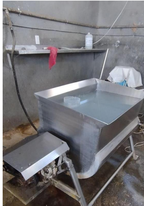
Figura 54 y 55 Cuba de doble fondo para elaboración de queso, vista frontal con motor del agitador (izq.). Vista lateral (der.)
