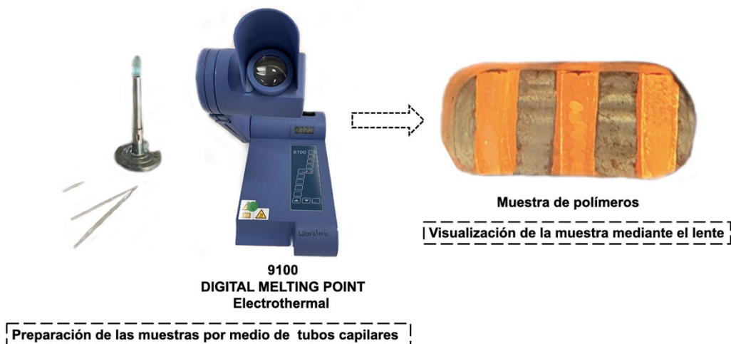
Figura 41. Proceso experimental de la determinación del punto de fusión de las muestras puras.
