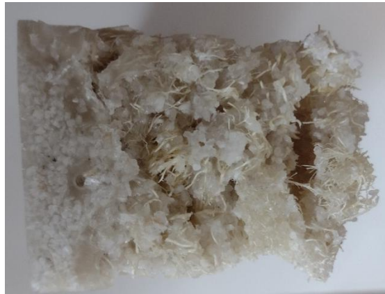
Figura 3.16. Deformación de probeta con 3% de Luffa.
