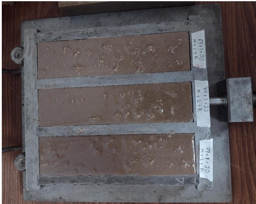
Anexo 5. Vaciado en molde, marmolina gruesa, resina Luffa
