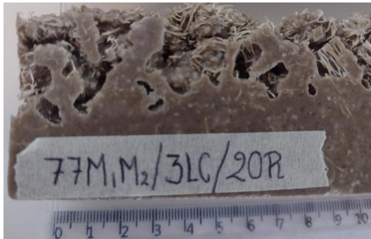
Figura 3.12. Probeta con 20 % de resina y 3% de Luffa.
