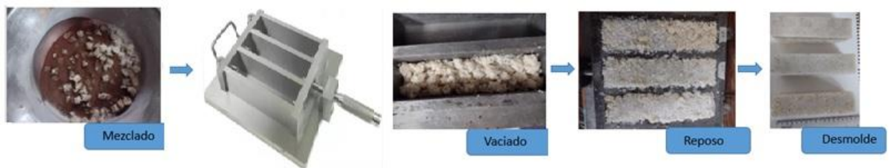
Figura 2.7. Etapas para la elaboración de las probetas de compresión y flexión.
