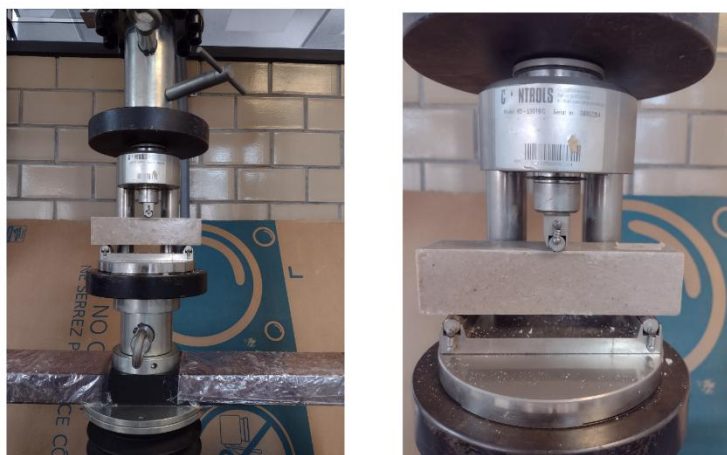
Figura 2.9. Prueba de flexión.
