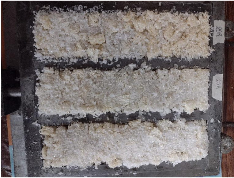
Anexo 5. Vaciado en molde, marmolina gruesa, resina Luffa
