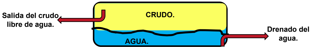
Ilustración 4. Deshidratación por sedimentación. Fuente: Elaboración propia.
