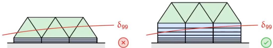
Figura A.15. Esquema que entrelaza la relación entre el espesor de la capa límite y las capas de resolución (Wimshurst, 2021).
