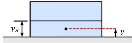
Figura A.16. Ilustración entre la distancia “ y ” al centroide de la celda y la distancia “ y_H ” relativa con la altura de la capa, medidas a partir de la pared del sólido (Wimshurst, 2021).
