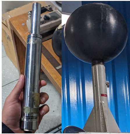
Figura 10: Detector centellador con tubo foto-multiplicador (izquierda) y esfera de Bonner (derecha).
