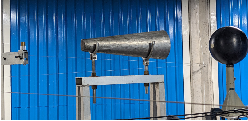
Figura 13: Arreglo experimental del método de conos de sombra, con la fuente del lado izquierdo, el cono de sombra en el centro y el detector dentro de la esfera de polietileno del lado derecho.
