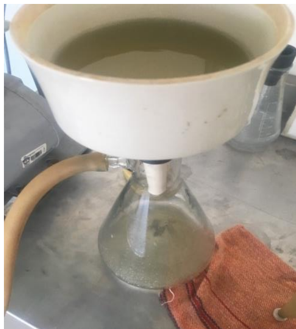
Imagen 3. Filtración del ART después del proceso de sedimentación, implementando un kit de filtración.
