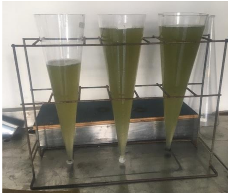
Imagen 2. Conos Imhoff con la muestra de ART para la sedimentación de material particulado.
