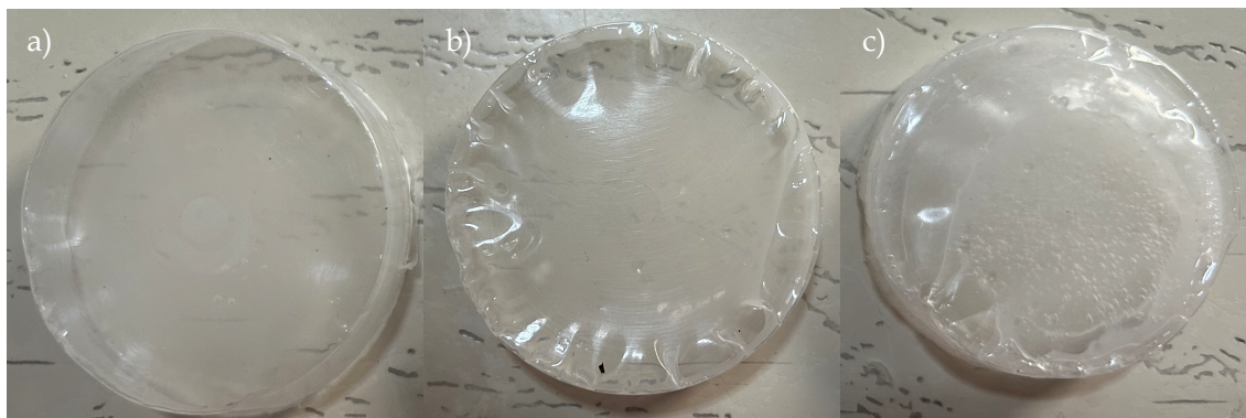
Figura 8. Muestra 3 ciclos CD con concentración: a) PVOH 10% CD b) PVOH 15% c) PVOH 20%
