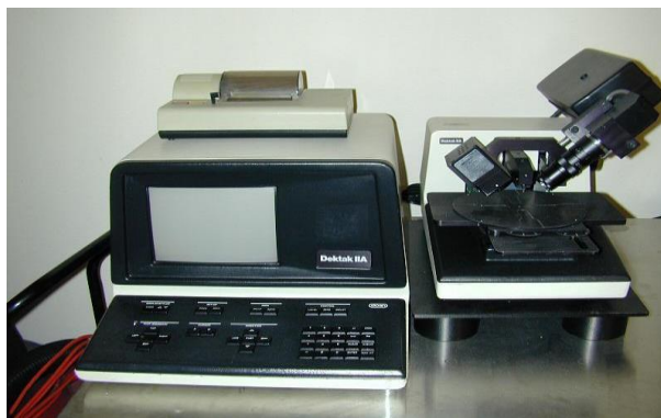
Figura 9. Perfilómetro utilizado para la medición de espesores.
