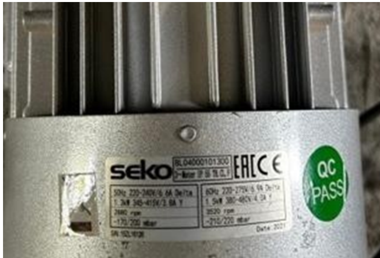
Figura 3.7: Fotografía de la placa de identificación del soplador
