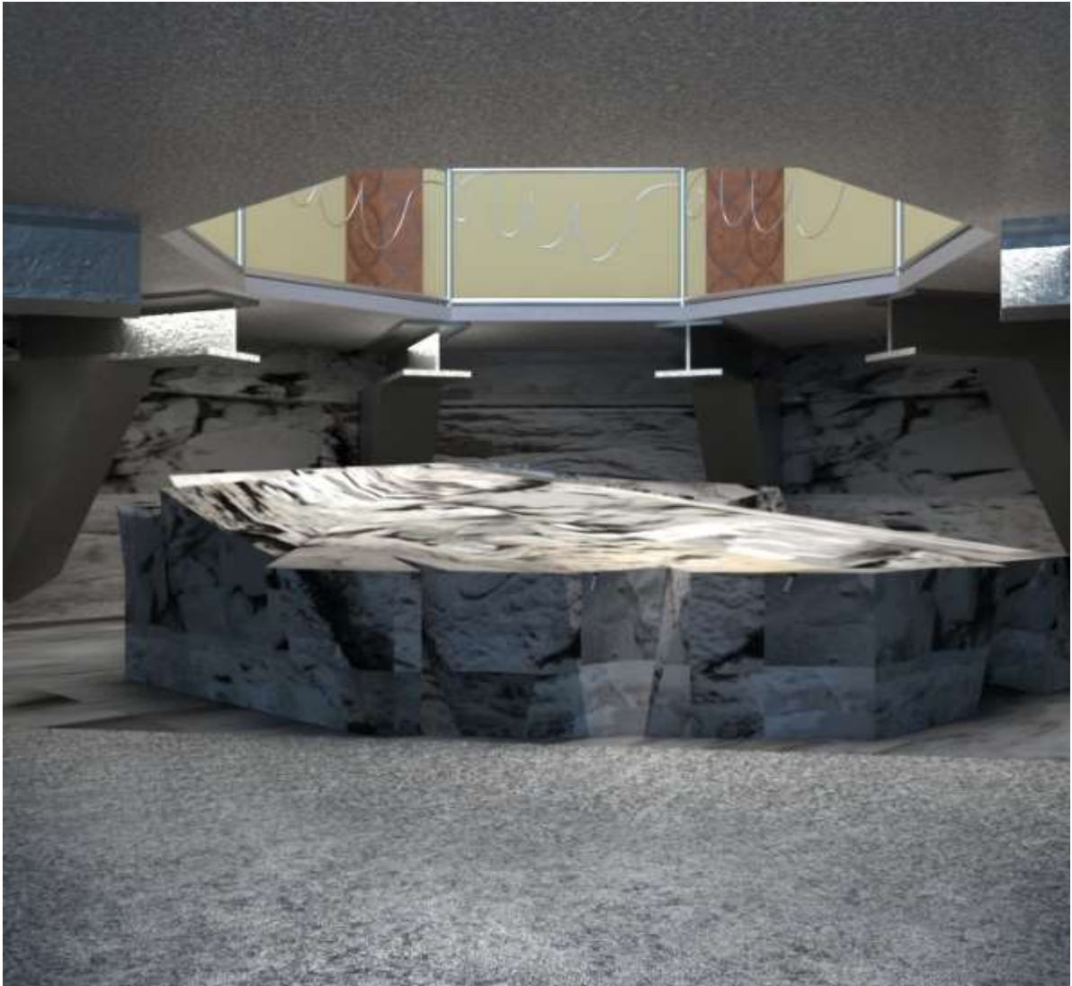
Imagen 36. Modelo Final en 3D de la colocación de ménsulas de carga para refuerzo de las vigas de acero en el interior del Torreón sur oriente.
