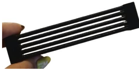
Figura 13. Fibras unidireccionales de PLA impresas en 3D
