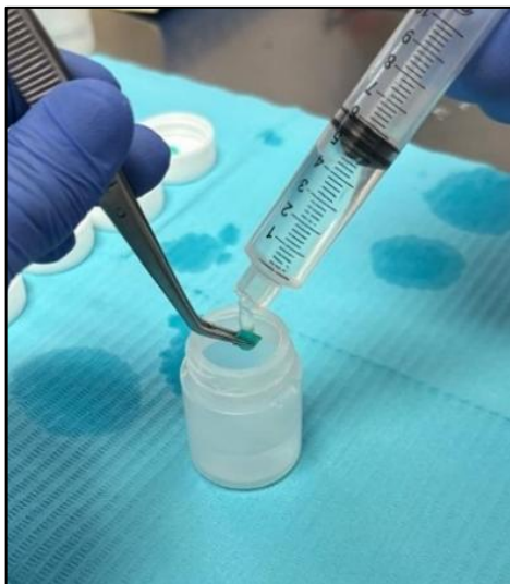
Ilustración 9 Agregación de solución TISAB II a muestras Twinky star. (fuente directa)
