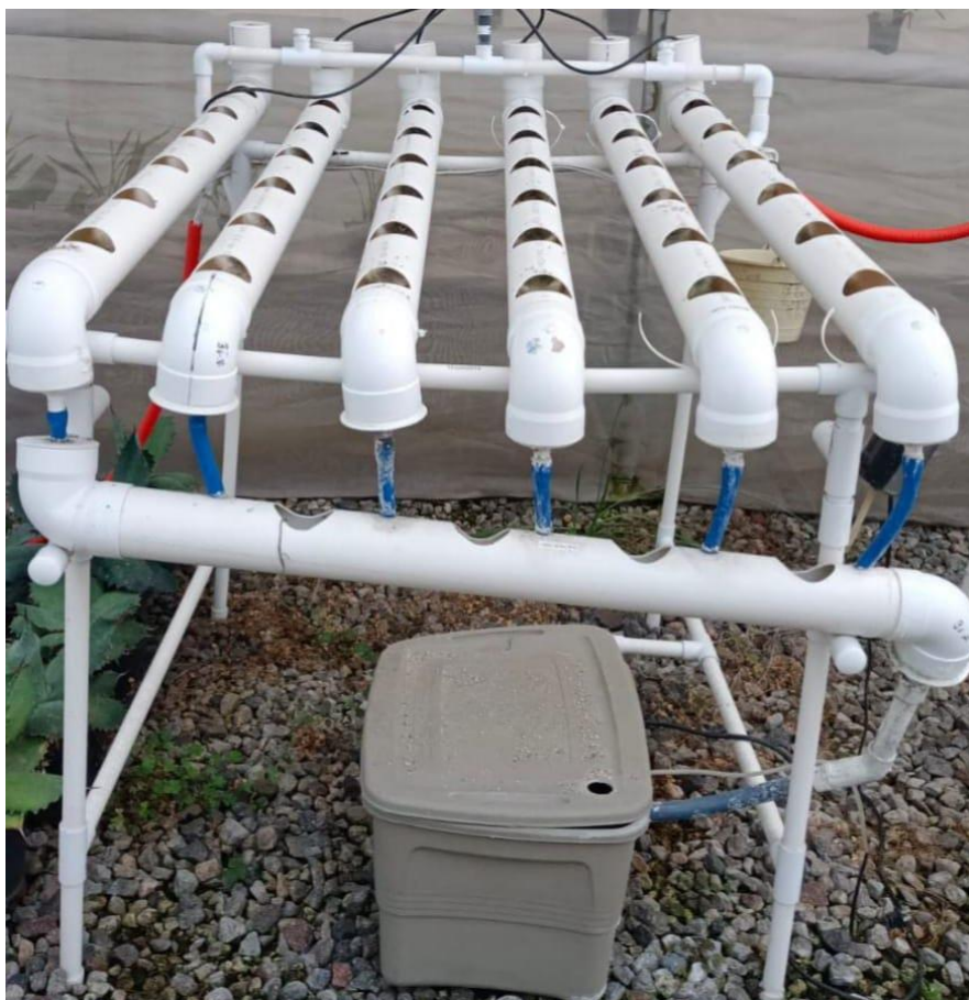
Figura 1. Sistema semi-hidropónico de PVC con capacidad para 40 plantas.
