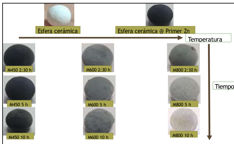
Figura 14. Esferas obtenidas a diferentes tiempos y temperaturas
